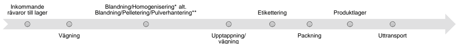
Figur 5. Processchema över produktionen från inkommande råvaror till utleverans av färdig produkt.
